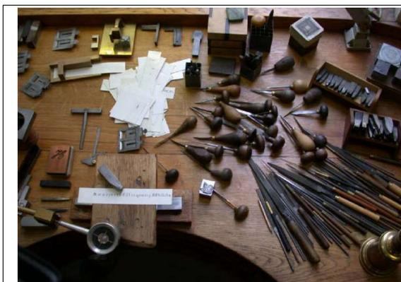
Fig.7: outils d'un graveur de poinçons
