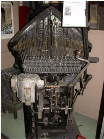
Fig.13 : la Typograph, machine linotype « à tringle ».
